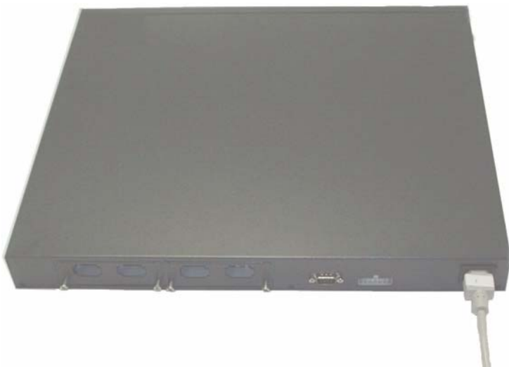
図 1-2 電源ケーブルの接続
